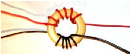
Beide Spannungsversorgungsdrähte im Gleichtakt gewickelt:
