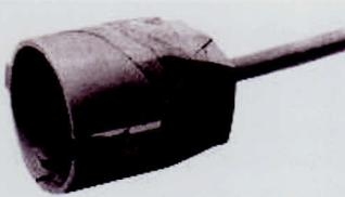
Abbildung 3: Beispiel einer aus dem Verkehr zu ziehenden Kupplung einer Anschlussleitung
