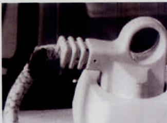
Abbildung 6: Beispiel einer sichtbaren Beschädigung einer Anschlussleitung
